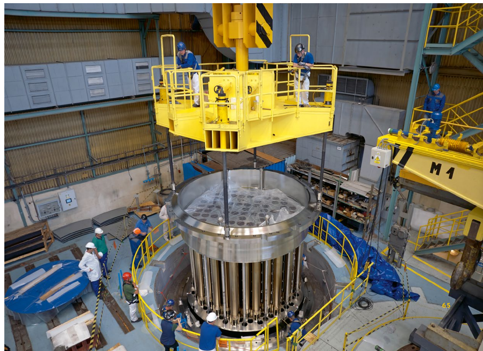
Obr. 18: Kontrolní montáž horních vnitřních částí reaktoru EPR (2023 – zveřejněno se souhlasem společnosti Framatome)
