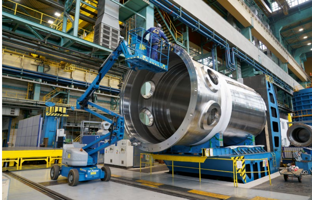
Obr. 12: Vnitřní šachta aktivní zóny reaktoru EPR (JE Hinkley Point C, 2023 – zveřejněno se souhlasem společnosti Framatome)
