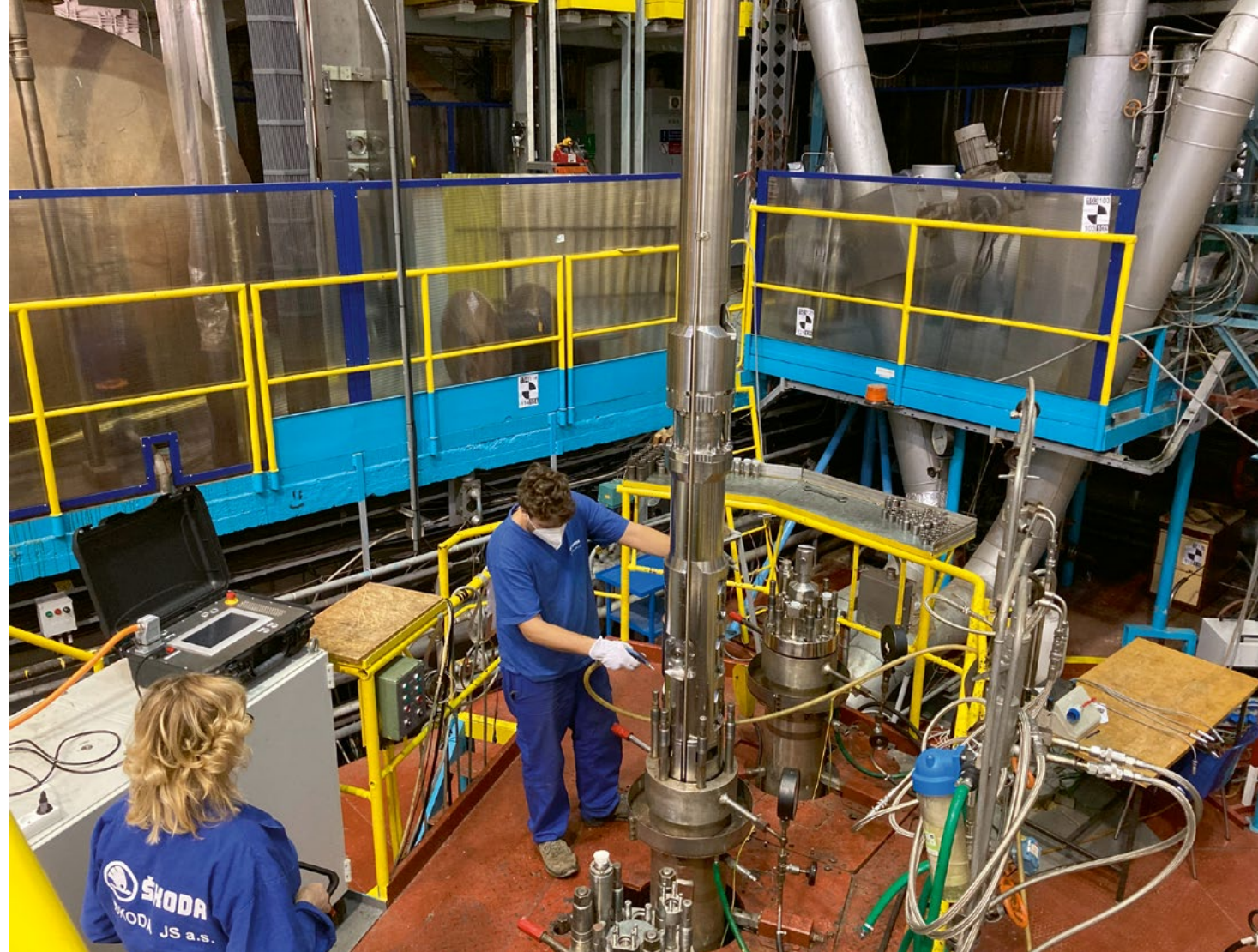
Obr. 14: Nová verze pohonů regulačních orgánů PRO-M v uplynulých letech nahradila na všech českých, slovenských, ukrajinských a maďarských jaderných blocích VVER-440 původní pohony s vyčerpanou životností (2022).
