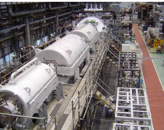
Obr. 10.7: Odstředivá kompresorová linka Elliott, a. Tříkompresorová linka (smontovaný stav), obrázek vlevo , b. Jeden kompresor (rozmontovaný stav), obrázek vpravo
