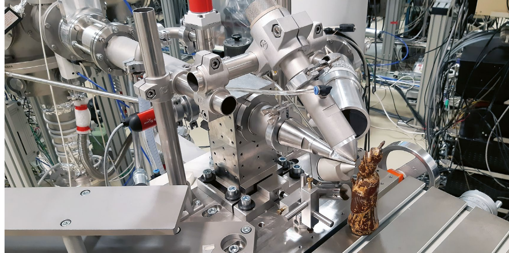
↑ Obr. 10: Charakterizace prvkového složení artefaktu svazky iontů z Tandetronu
