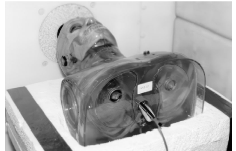
↑ Obr. 6: Busta člověka pojmenovaná „kamarád“, která se používala při vývoji BNCT metody na reaktoru LVR-15 (zdroj: ÚJV Řež, a. s.)
