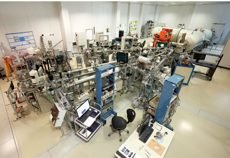
↑ Obr. 8: Urychlovač Tandetron (foto: archiv CANAM)
