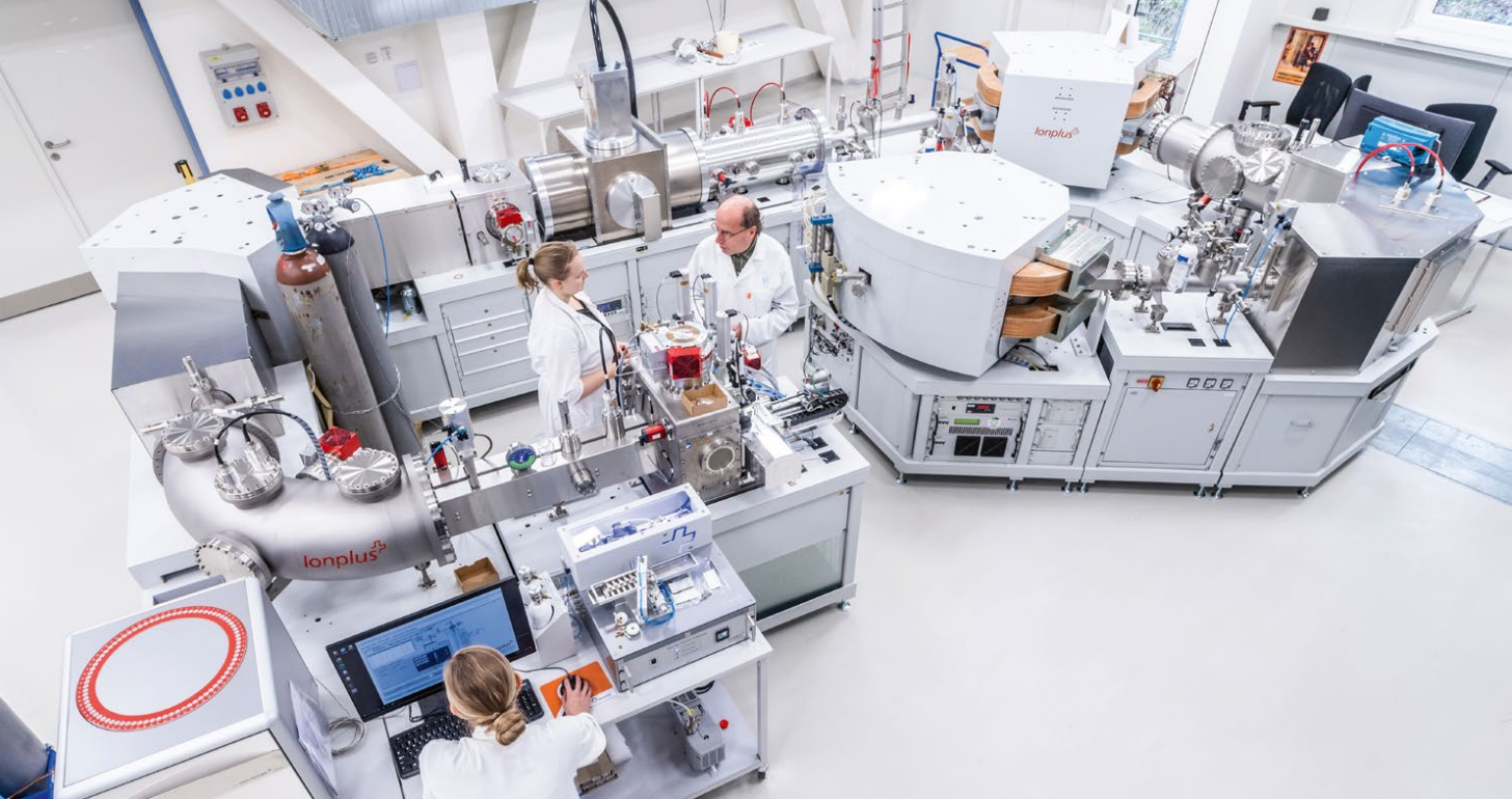
↑ Obr. 11: Kompaktní urychlovačový hmotnostní spektrometr AMS MILEA (foto: AV ČR – Jana Plavec)
