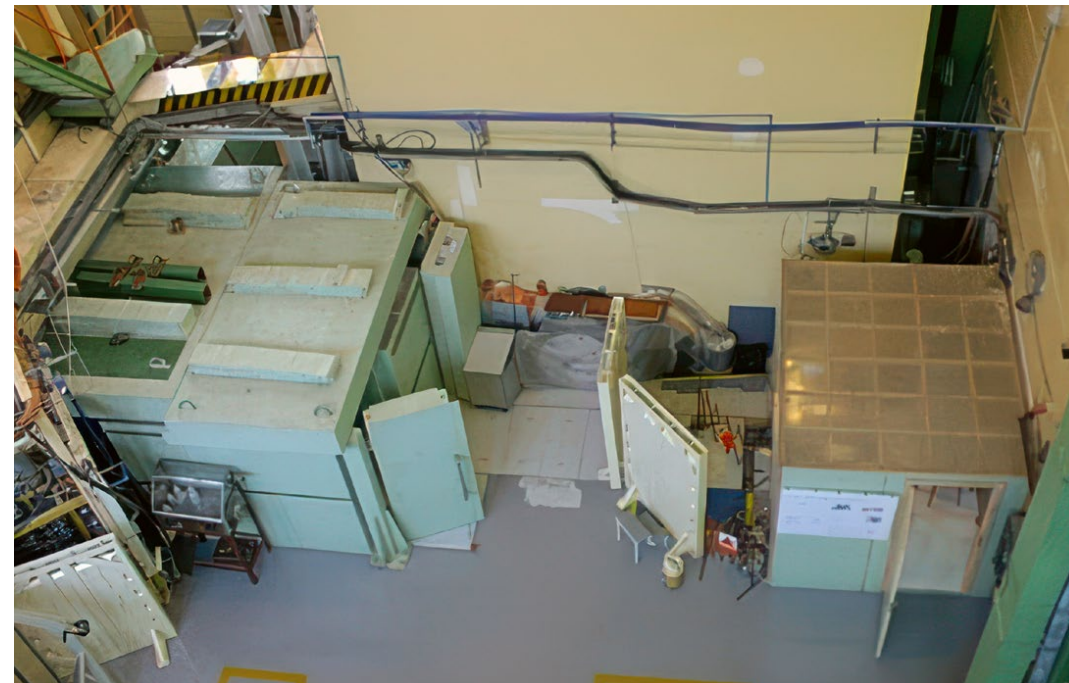
→ Obr. 1: Pracoviště NZT na reaktoru LVR-15, vlevo betonová ozařovací místnost, vpravo lehká ovládací buňka
