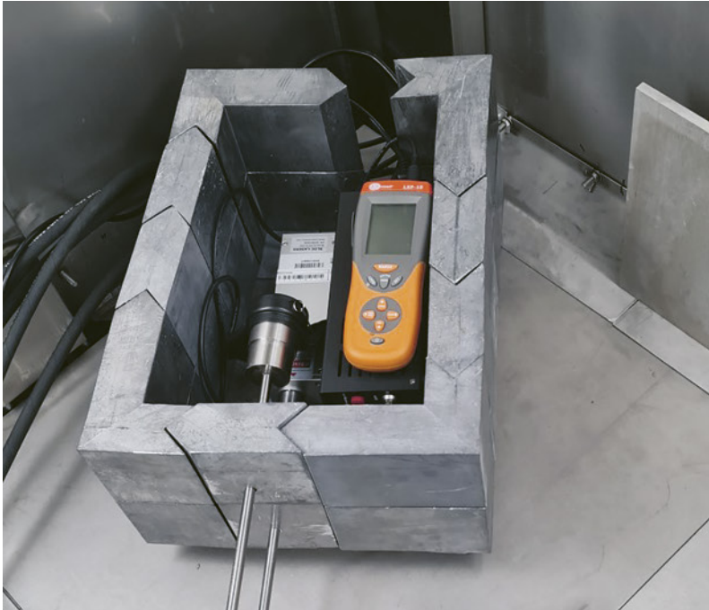
Obr. 12: Radiačně stíněný olověný bunkr pro ochranu citlivé elektroniky sondy před účinky ionizujícího záření
