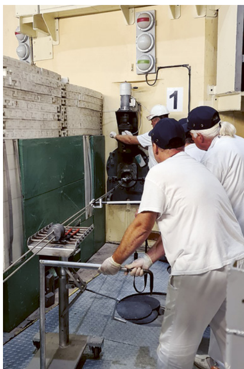
Obr. 22: Olověná stínící zátká průměru 96 mm a celkové výšky 90 mm, pro zastínění ústí horizontálního kanálu výzkumného reaktoru LVR-15
