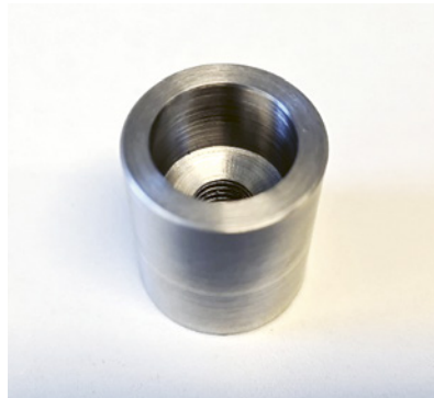
Obr. 6: Redukční prvek pro připojení vstupního světlovodu k laserovému zdroji
