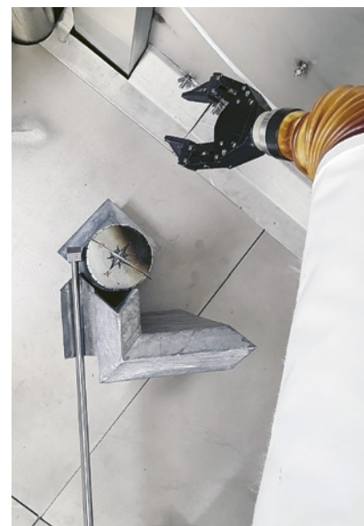
Obr. 16: Kamerový pohled na detail uložení plechovky s vysokoaktivním ZIZ za stínícím paravánem
