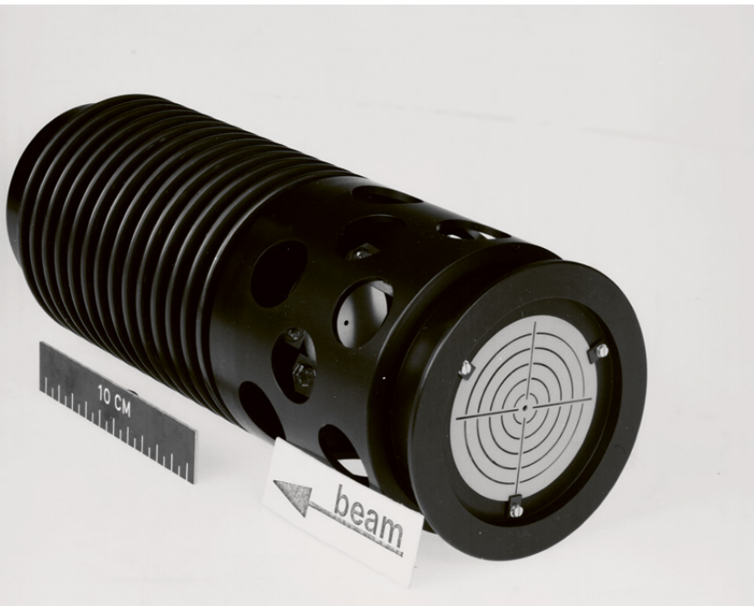
↑ Obr. 2 Terč pro produkci antiprotonů v laboratoři CERN. Dopadají na něj protony s energií 26 GeV z protonového synchrotronu PS (zdroj: Photographic Service CERN PhotoLab)
