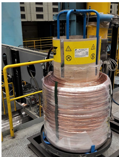
Obr. 6: Velkokapacitní cívka se svařovacím drátem o hmotnosti 1 000 kg
