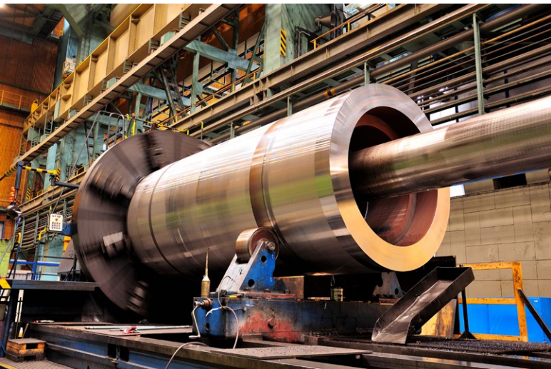
Výroba kontejneru ŠKODA 1000/19 na soustruhu v Reaktorové hale v Plzni
