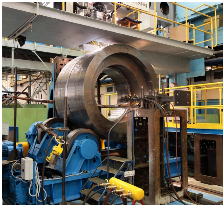
Obr. 3: Pracoviště a zkušební spoj pro svaření kvalifikace WPQR
