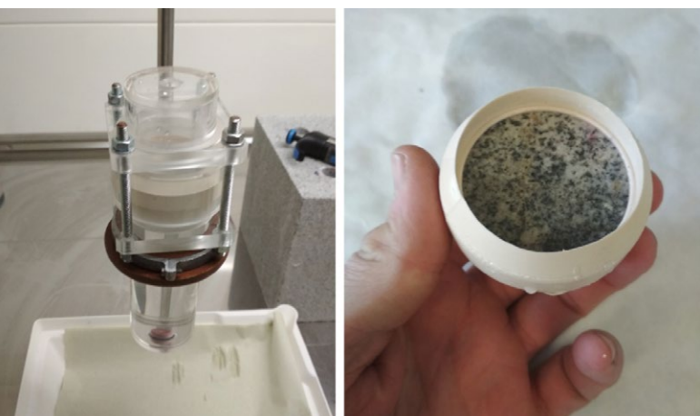
Obr. 17: Difuzní cela s geologickým vzorkem
