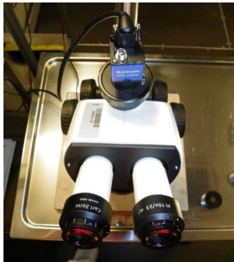
Obr. 6: Příklady standardního laboratorního vybavení – stereolupa (nahore), metalografická bruska a leštička (dole)
