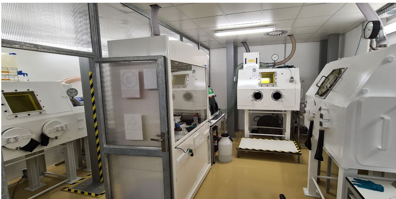
■ | Obr. 4: Stíněné rukavicové boxy a radiochemická digestoř v Přípravně ozářených geologických vzorků, stavebnin a keramiky |
