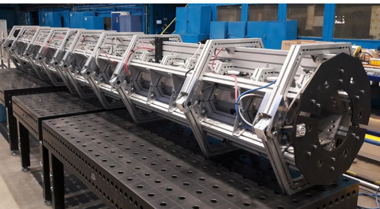
Obr. 8: Přípravek pro přesné sestavení šestihranné trubky
