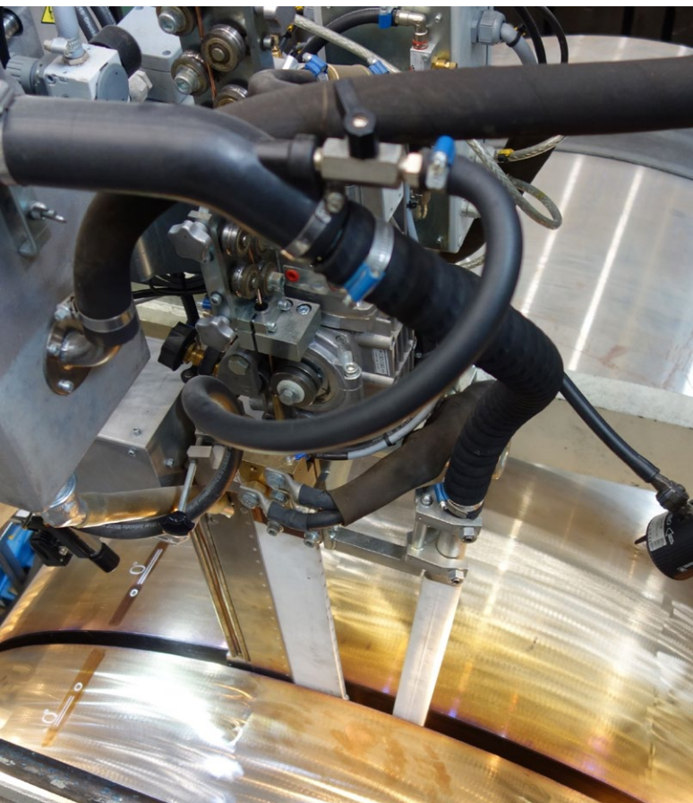
Obr. 2: Svařovací hlava v úkosu během svařování
