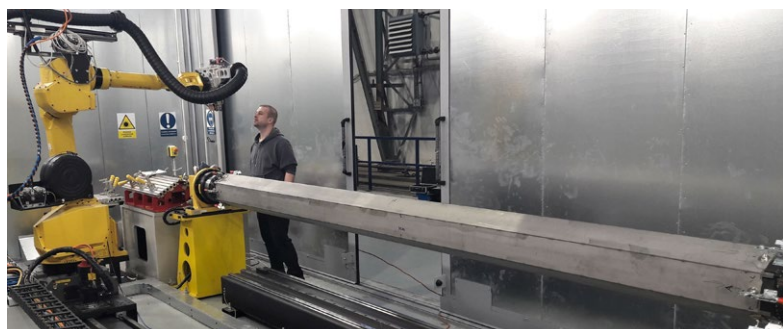
Obr. 9: Pohled do komory na pracoviště laserového svařování s šestihrannou trubkou upnutou do svařovacího přípravku a připravenou pro svařování
