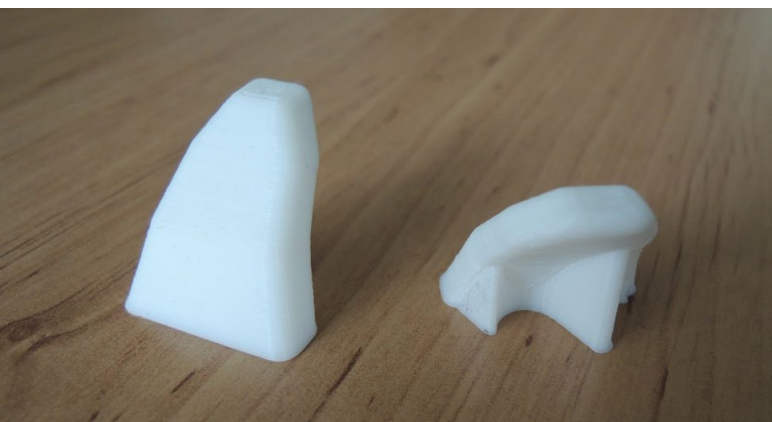
Obr. 3: Návrh divertorů pro hlavice Westinghouse
