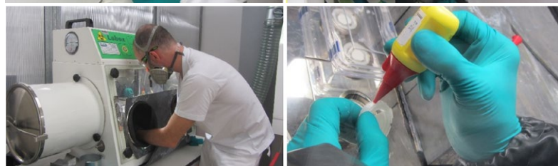
▮ Obr. 9: Mlecí nádoba mlýnku se zirkoniovou kuličkou určenou k drcení vzorků na prášek ▮
