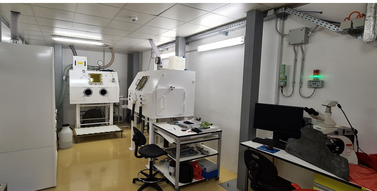
Obr. 13: Radiačně zastíněný světelný optický mikroskop (LOM) – vpravo
