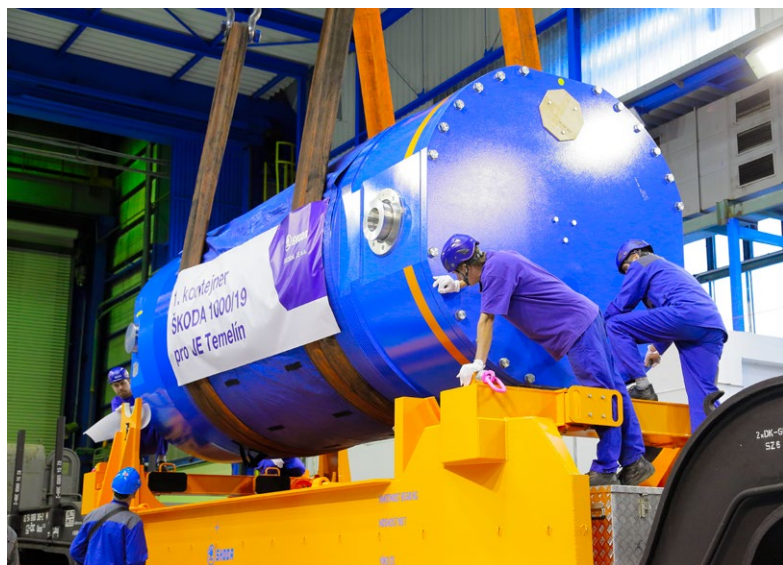
Obr. 4: První kontejner ŠKODA 1000/19 při transportu na JE Temelín |
