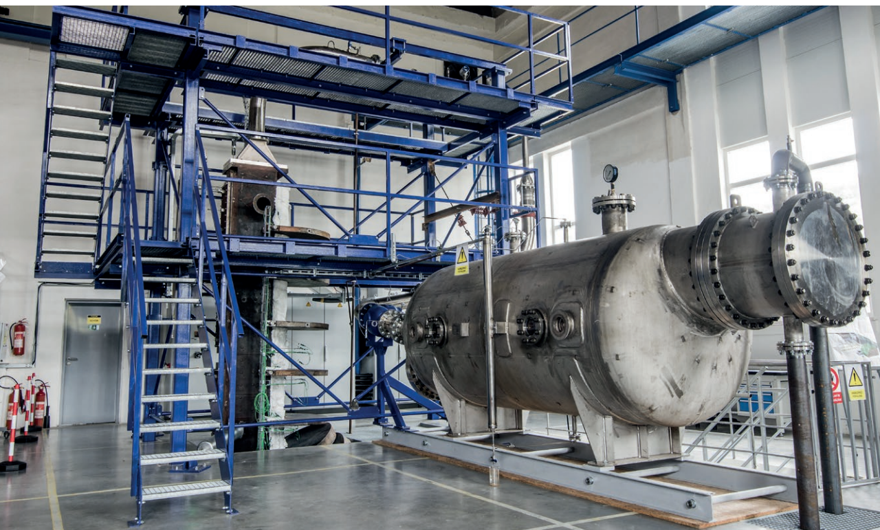
Obr. 7: TSH-15 Pohled na kondenzátor a armaturu, modelující zúžený průchod páry v oblasti opor reaktoru
