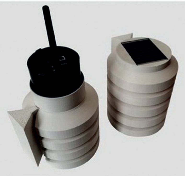
Obr. 3: Radonové sondy TERA v provedení pro venkovní použití se solárním dobíjením
