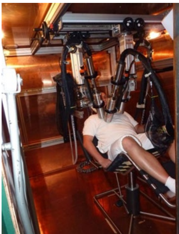
Obr. 1: Unikátní sestava 4 HPGe detektorů v kobce celotělového počítače určená pro stanovení radionuklidů s nízkými energiemi záření gama a X (obvykle v lebce) nebo pomocí 3 detektorů v plicích
