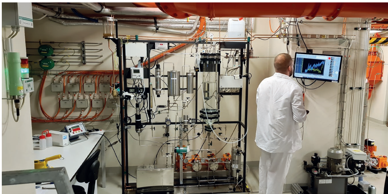
Obr. 24: Vodní smyčka autoklávového zatěžovacího systému
