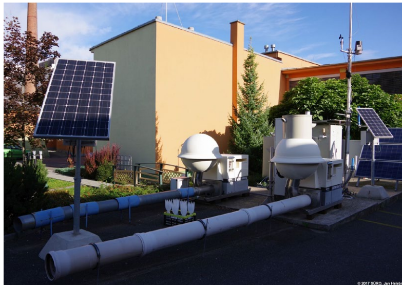
Obr. 2: Dvě odběrová zařízení aerosolů „Snow White“ s průtokem 900 m 3 /h, s on-line měřením radionuklidů nad aerosolovým filtrem (scintilační detektor pod kopulí, HPGe detektor) a automatickým přenosem dat pro citlivá měření radionuklidů v ovzduší
