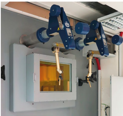
Obr. 2: Průzor z olovnatého skla tloušťky 900 mm s párem dálkových manipulátorů
