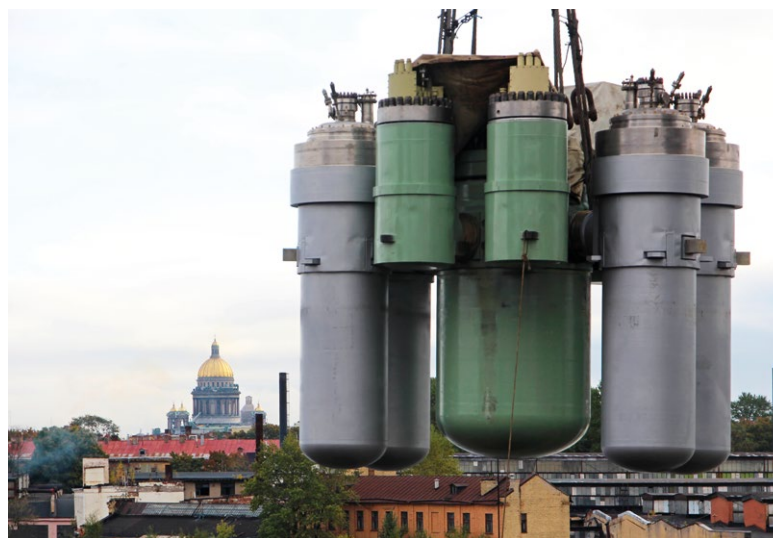
■ | Montáž reaktorů jednoho z reaktorů KLT-40 S v loděnicích v St. Petersburgu |
